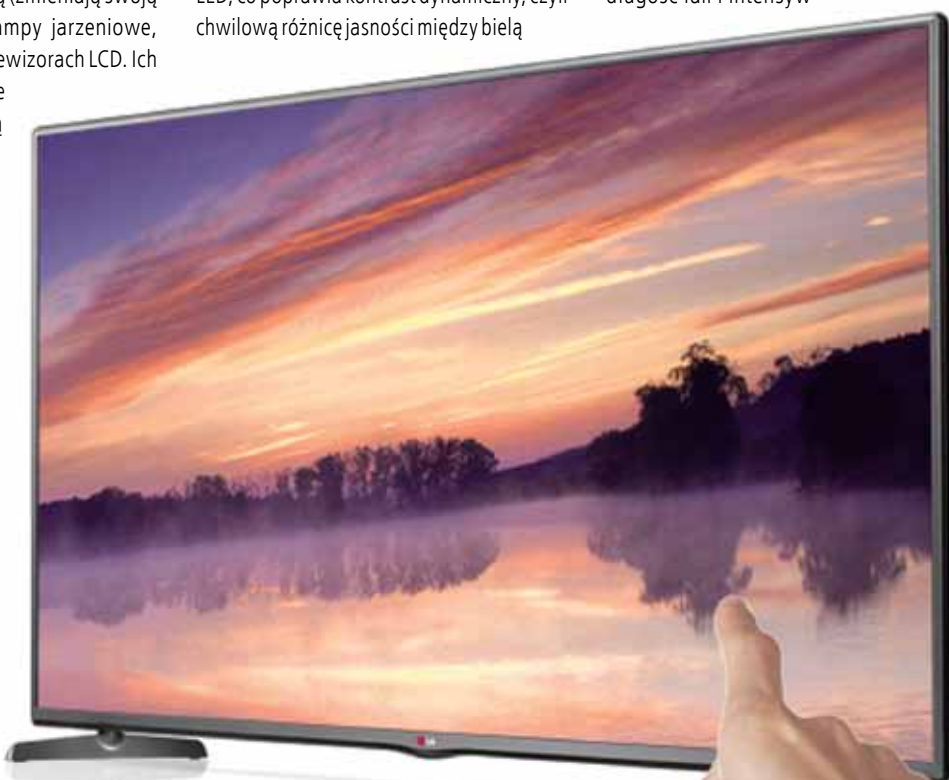
Powierzchnia wyświetlacza IPS nie ugina się pod wpływem dotyku.
