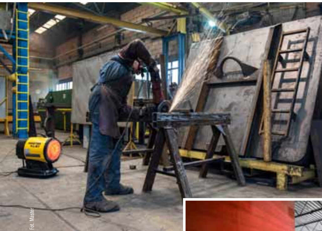
Promiennik na olej opałowy lub napędowy Master XL 61 z redukcją spalin.
