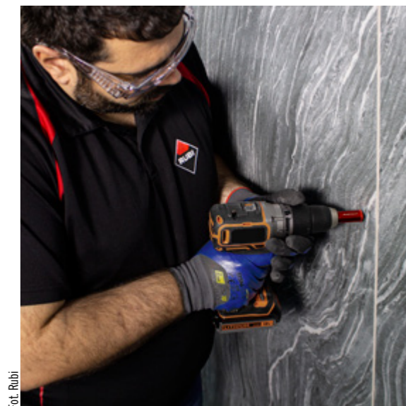
Wiertła diamentowe Drygres 4Drill mają w środku wosk. Wosk topi się podczas użytkowania wiertła i poprawia chłodzenie.
