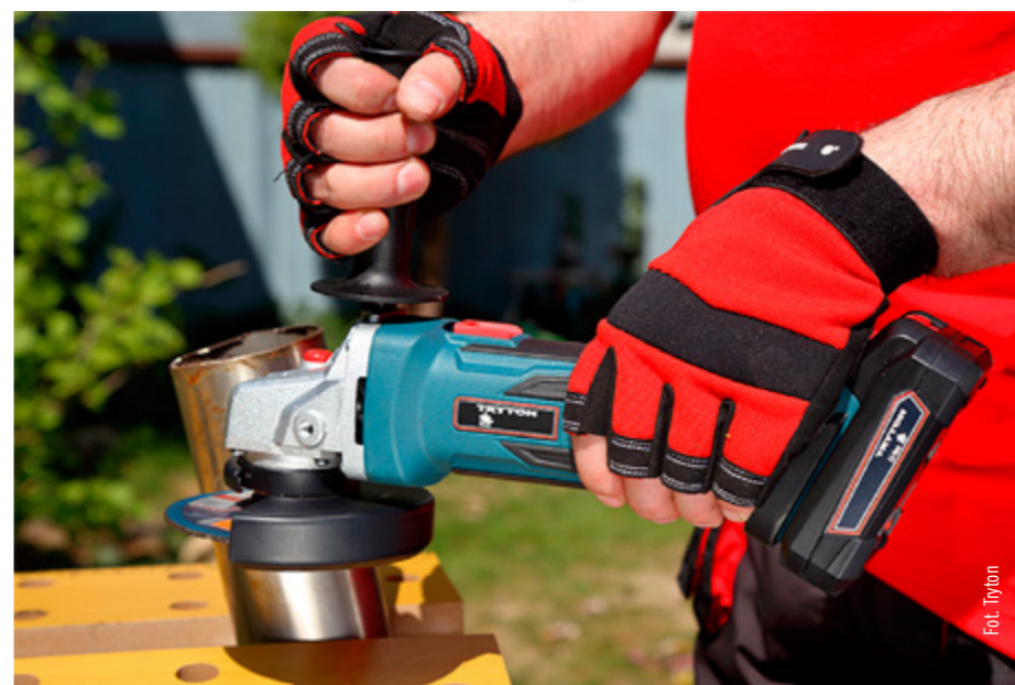
Szlifierka kątowa Tryton TJS40 obsługuje tarcze o średnicy 115 mm i może skutecznie ciąć i szlifować elementy metalowe.
