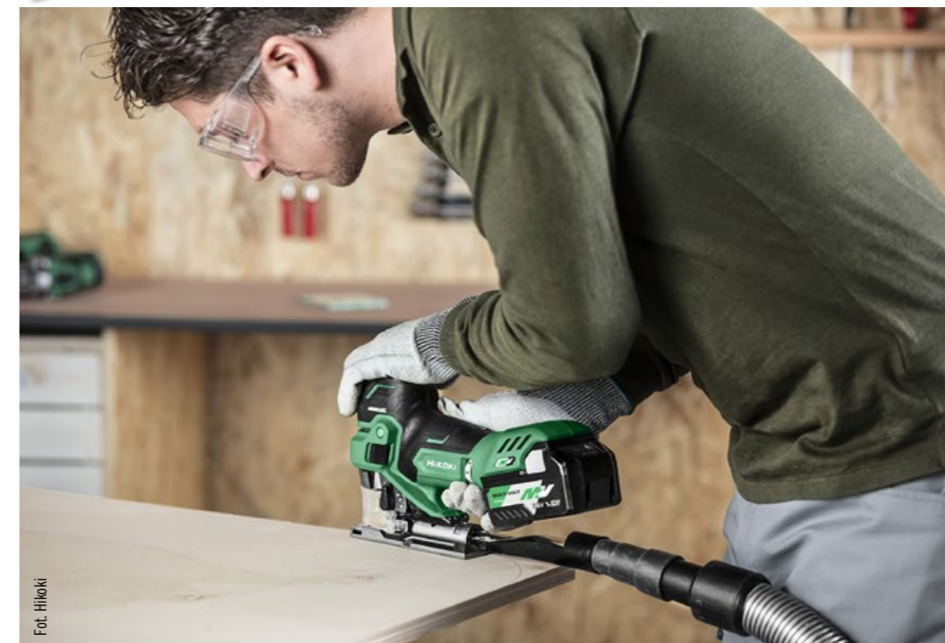
Wyrzynarka Hikoki CJ36DB W2Z dotłączona do odkurzacza praktycznie usuwa wióry z miejsca cięcia.
