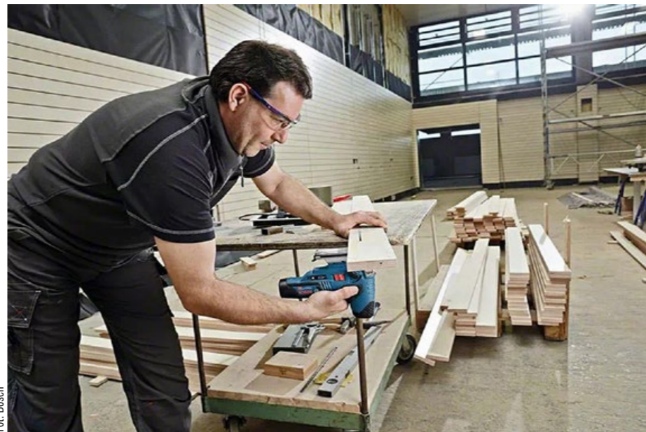
Możliwość cięcia od dołu dzięki zwartej i ergonomicznej budowie wyrzynarki Bosch GST 12V-70 Professional.
