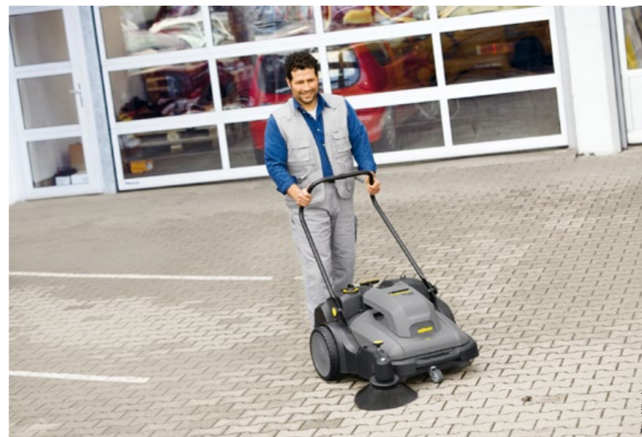
Zmiatarka profesjonalna Kärcher KM 70/30 C Bp Pack Adv prowadzona ręcznie z elektrycznie napędzonymi szczotkami główną i boczną z akumulatora.
